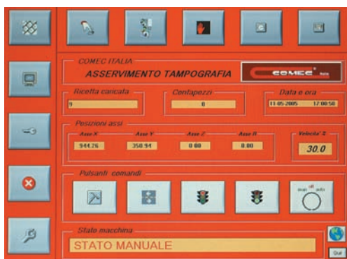
Figura 7 Pannello touch screen per la programmazione, il controllo e la diagnostica di tutto il processo di lavorazione
